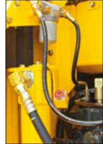
Фильтр управляющего контура Дополнительный фильтр для гидромолота
