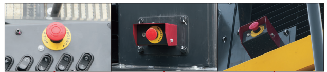
Кнопки остановки двигателя и блокировки запуска
