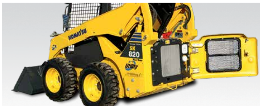
Задняя дверь: удобная проверка и очистка радиаторов
