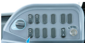
Переключатель двух режимов мощности двигателя
